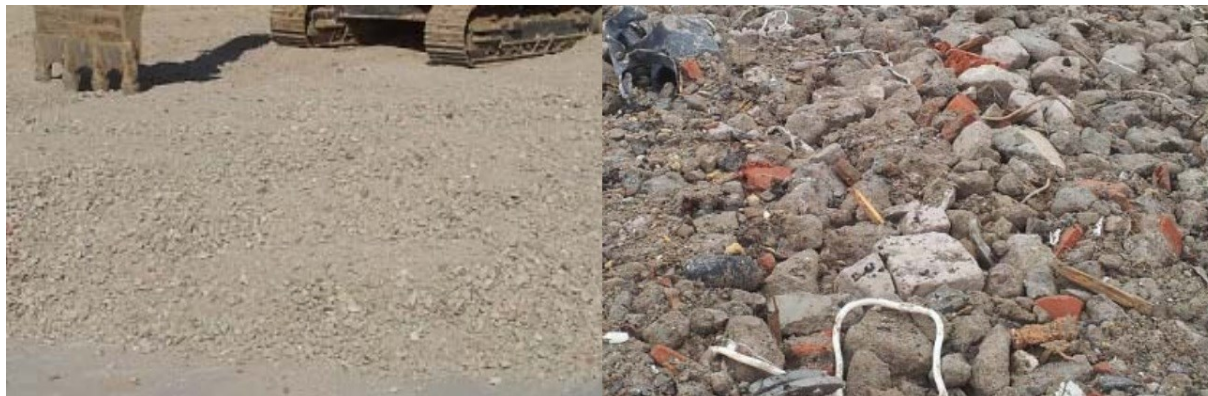
Kuva 3. Laatuvaatimukset täyttävä (vasen) ja laatuvaatimukset alittava (oikea) betonimurske.
